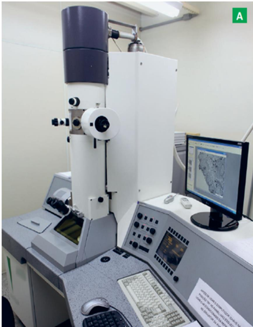
Figura 6.6 A: microscópio eletrônico de transmissão (Instituto Butantan, São Paulo, SP, 2012); B: esquema do microscópio; as lentes e os condensadores são eletroímãs para desviar o feixe de elétrons que atravessa o objeto e forma a imagem; C: célula humana com aumento de cerca de 10 mil vezes (imagem colorizada por computador). (Os elementos do esquema não estão na mesma escala; cores fantasia.)
